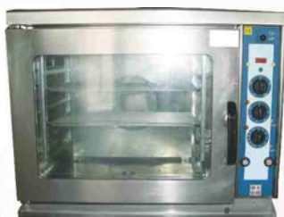
Конвектомат за 7 тави мощност 8 киловата трифазен вис. 80 см, шир. 90 см, дълб. 90 см арт. № 8002
