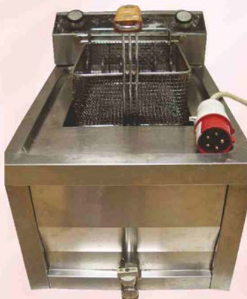
Фритюрник електрически трифазен, мощност 5 kw обем на съда 7 л
